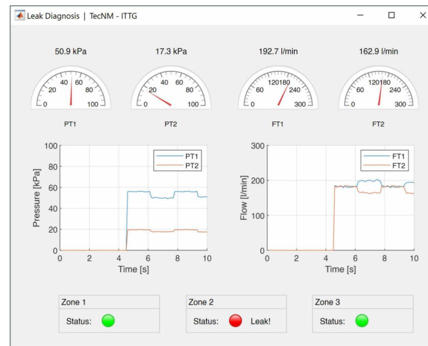
Figura 2. Prueba de localización de fugas en tiempo real.
