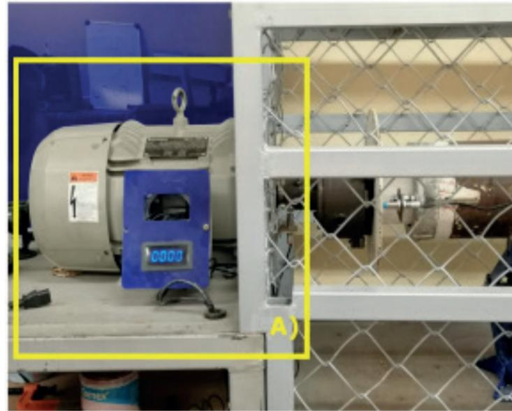
Figura 2. Banco de pruebas para aerogeneradores de baja potencia.
