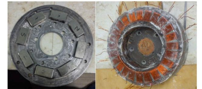
Figura 2. Rotor y estator construido del GEFAIP.
